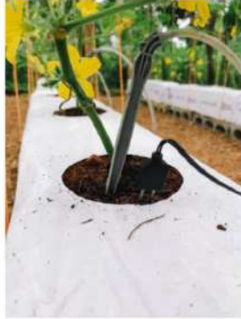
Fig. 2 Sensor de humedad en el sustrato
