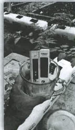
Figura #1 Medición de pH y conductividad eléctrica en el nutriente.
